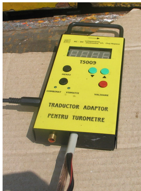
Fig. 6 Tahometru electronic T5009 determinarea regimurilor motorului MMT45
