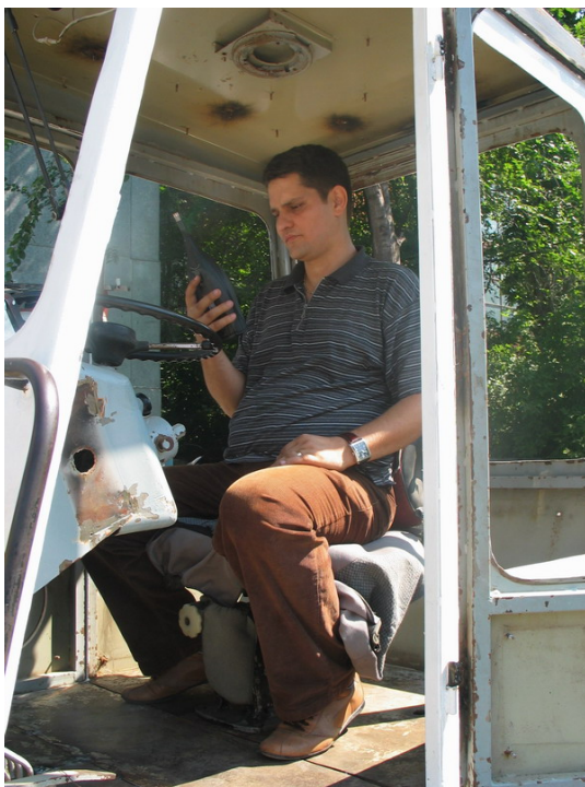
Fig. 3 Determinarea nivelului intensității sonore în interiorul cabinei MMT45
