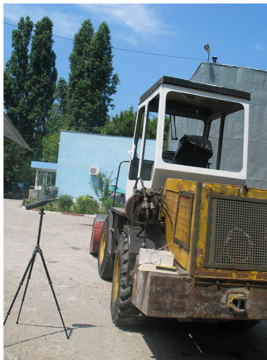
Fig. 4 Determinarea nivelului intensității sonore emise în mediu de MMT45
