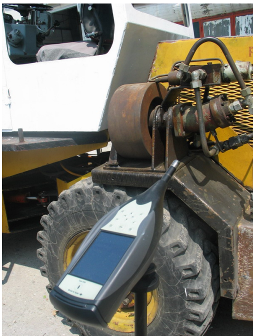
Fig. 5 Sonometru-analizor portabil Brüel&Kjær type 2250
