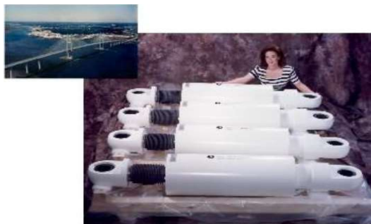
Fig. 2 Amortizori fluidici pasivi utilizați în construcția podului Sidney Lanier – SUA
