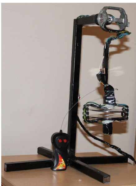
Fig. 1 Dublul pendul giroscopic
