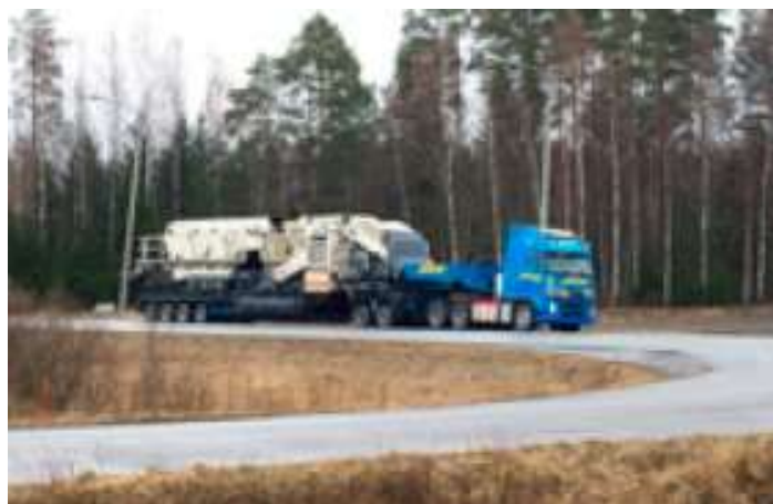
Fig. 5. Instalație mobilă de concasare cu con LT 330D compactă- faza de transport
