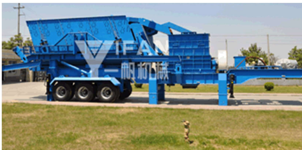
Fig. 1. Instalație mobilă de concasare pentru cărbune (firma YIFAN)
