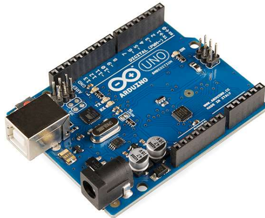
Figura 3 – Placă de dezvoltare Arduino UNO [2]
