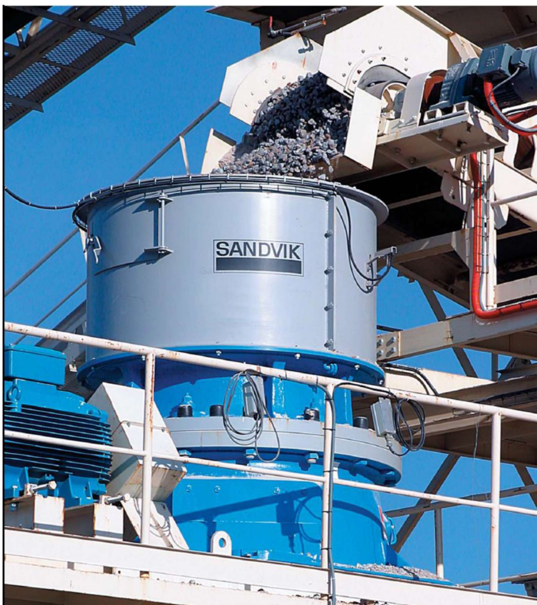
Figura 2. Concasor cu con fabricat de firma producătoare SANDVIK
