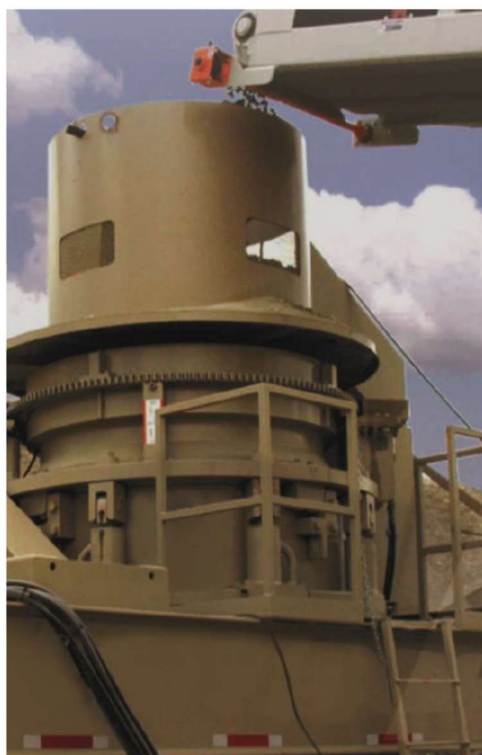
Fig.3. Concasor cu con Kodiak (capacitate până la 625t/h)
