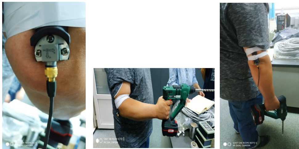
Figura 5 – Fixare accelerometru și calibrare
