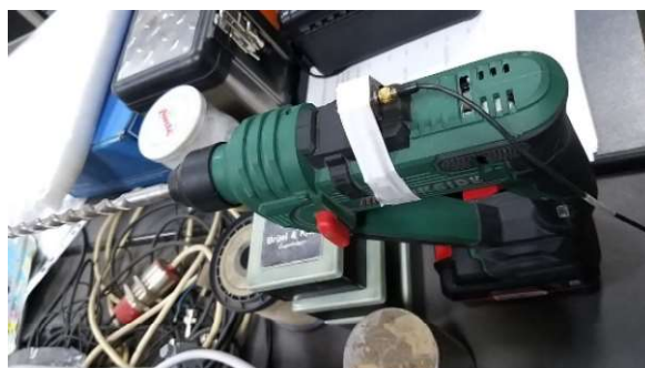
Figura 4 – Fixare accelerometru și calibrare
