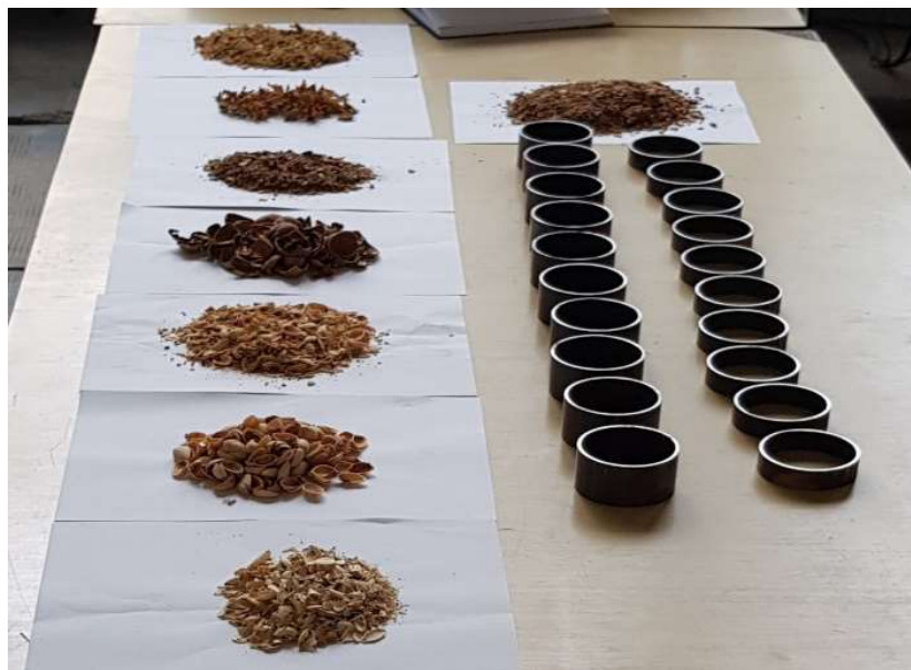
Fig. 1. Elemente pentru pregătirea epruvetelor cu materiale biocompozite (materia primă și limitatoare cilindrice)
