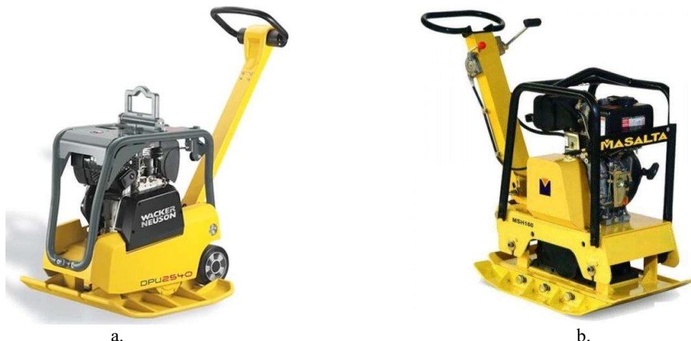
Fig. 1. Placă compactoare vibratoare [10]
