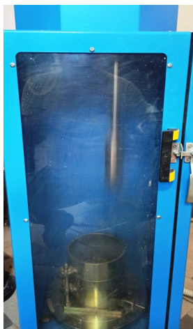
c. probă - în compactor Proctor
