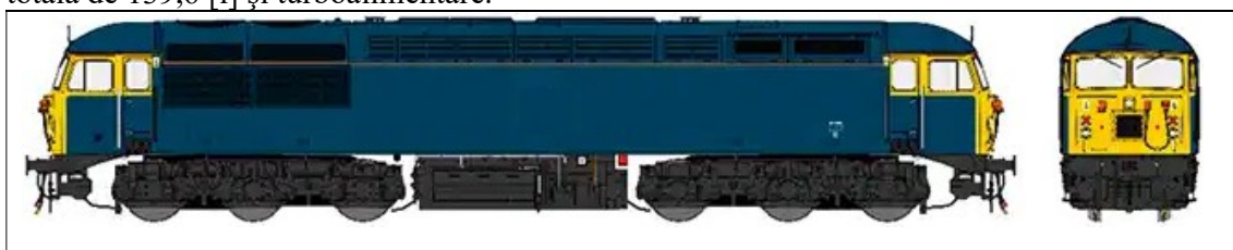
Fig. 1. Schema locomotivei diesel electrice britanice clasa 56 „Gridirons”, având o putere instalată de 2423 [kW], cu motor termic de tracțiune românesc tip 16 R 251, în patru timpi, cu 16 cilindri dispuși în V pe două distribuții, cu formula osiilor: Co'Co', de ecartament normal: 1435 [mm] și atingând viteza maximă de 129 [km/h].
