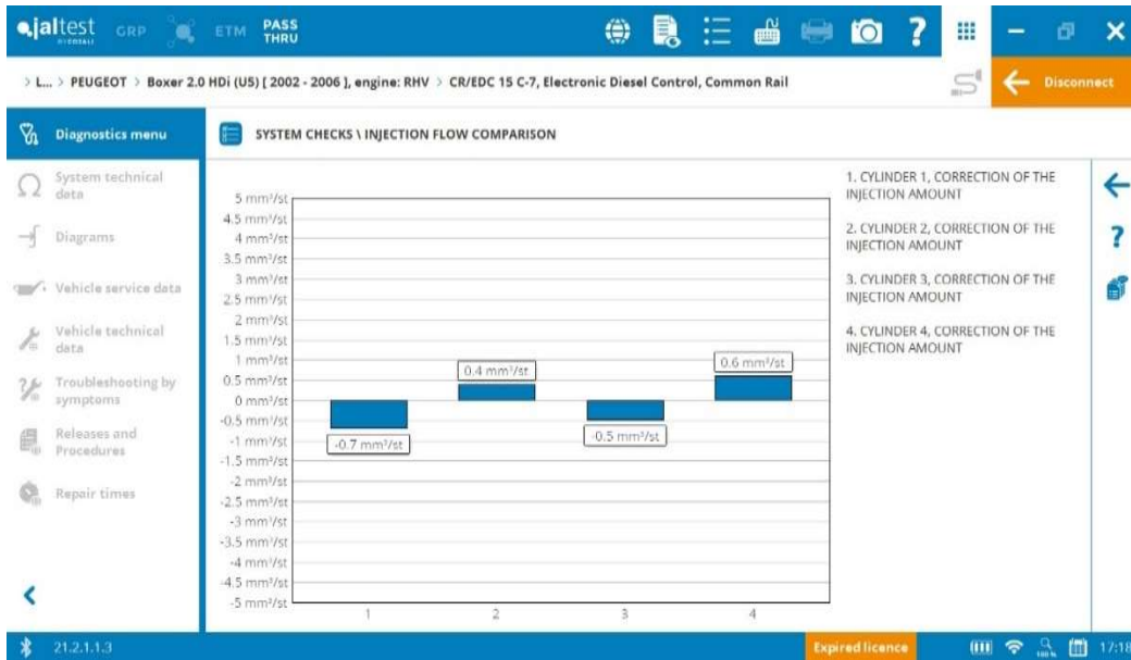
Fig. 7 Test de comparație cantități activat, funcționare normală
