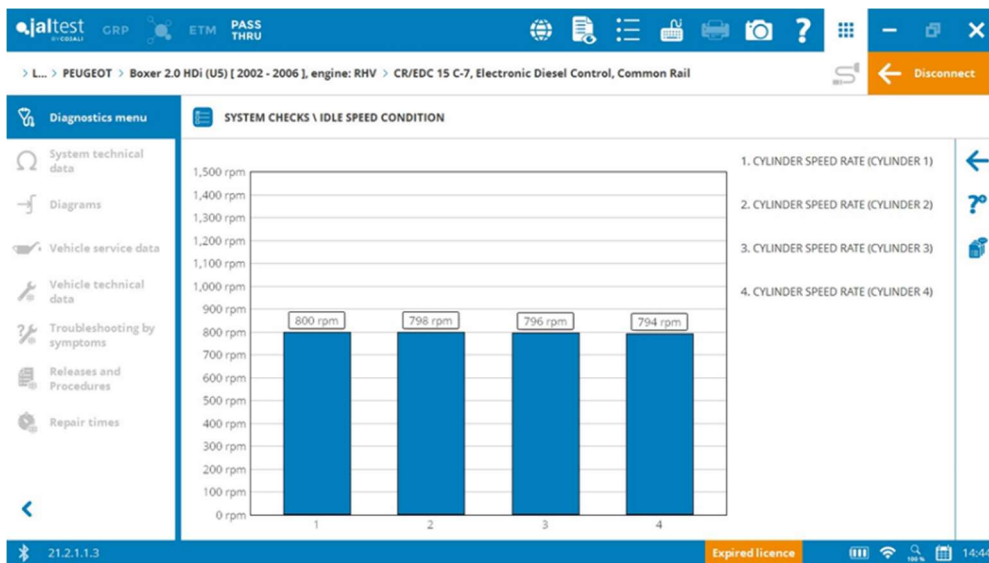
Fig. 5 Compararea turațiilor la ralanti pe fiecare cilindru
