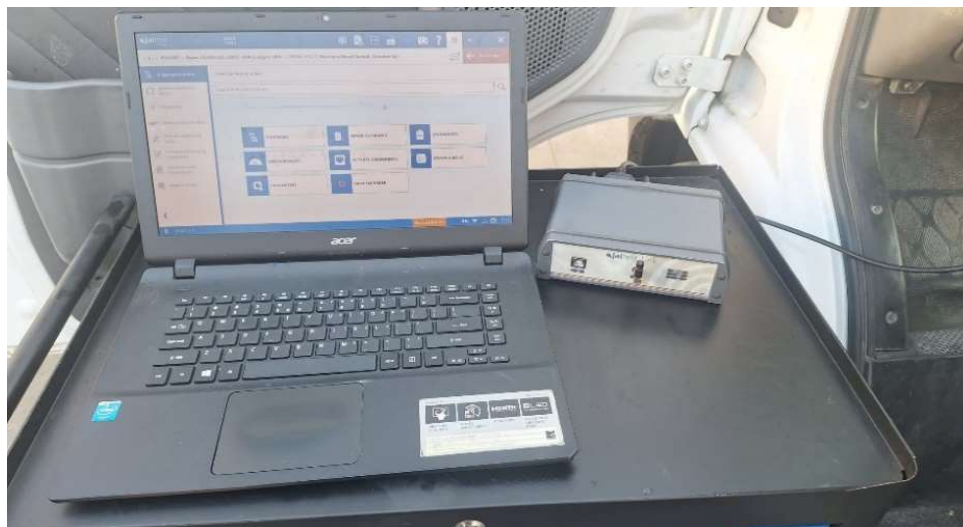
Fig. 3 Interfață de diagnoză profesională marca Jaltest
