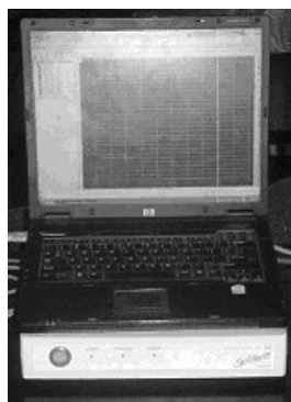
Fig. 6. Calculator portabil conectat la puntea tensometrică SPIDER 8
