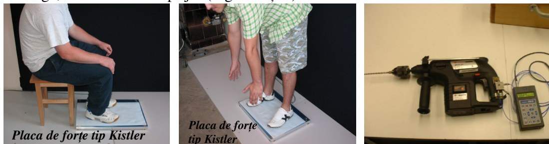
Fig.4. Pozițiile inițiale ale subiecților – fără unealta vibratorie și respectiv măsurarea nivelului de vibrații pe unealta vibratorie [5]
