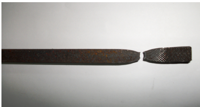
Fig.5 Zona de rupere in cazul barelor incalzite
