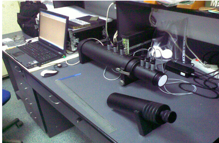
Fig. 1. Tub Kundt de citire a impedanței
