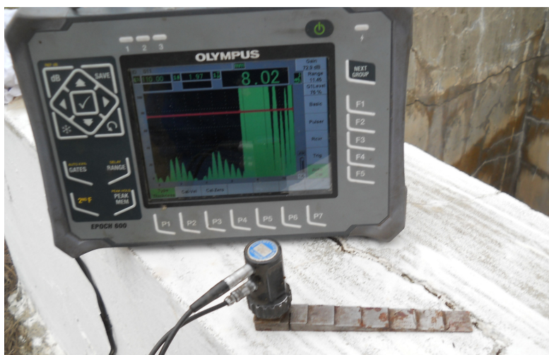
Fig. 2.3.1. - Aparat utilizat la examinarea cu ultrasunete: tip EPOCH 600 și calibrarea defectoscopului înainte de începerea examinării.
