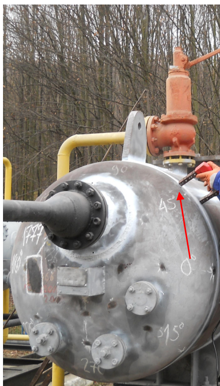
Fig. 2.2.1. Examinarea sudurilor circulare cu pulberi magnetice utilizând jugul electromagnetic de curent alternativ.
