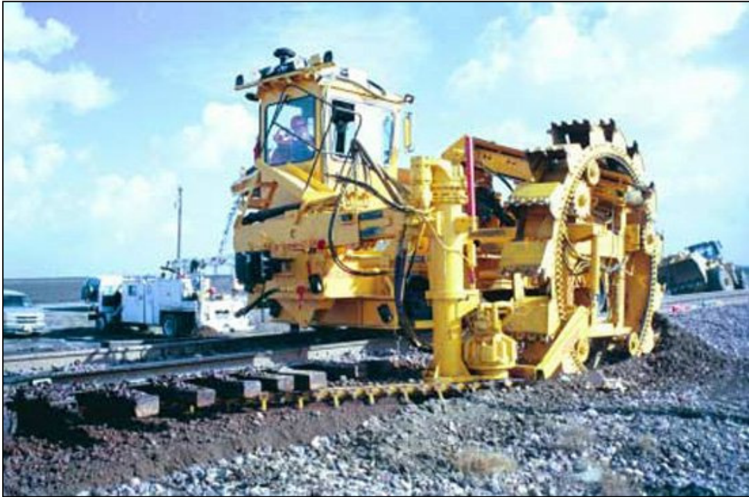
Fig.8 Mașina combinată pentru extragerea în totalitate a materialul prisme de balastare, tip KSU 300 Switch Undercutter, produsă de firma Knox Kershaw Inc.
