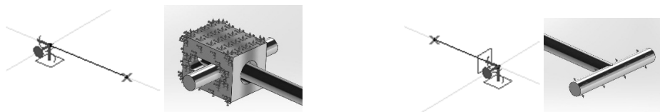
Fig.5 Modelarea schemei de rezemare, AxisVM/SolidWorks
