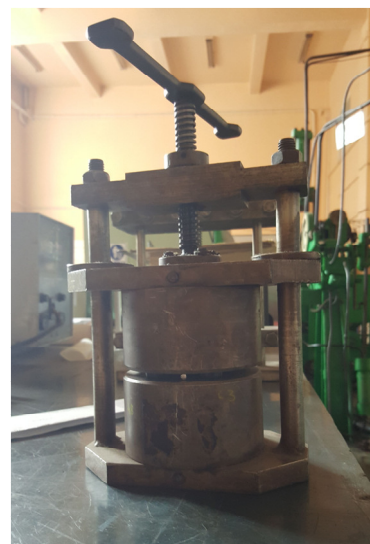
Figura 8 Epruvete în timpul comprimării, în interiorul dispozitivului
