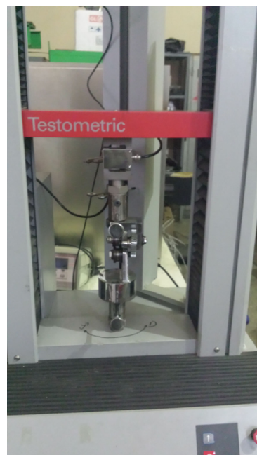
Figura 5 Epruveta inelară la sfârșitul încercării
