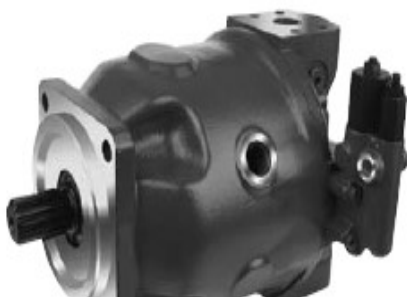
Pompa principală cu pistoane axiale și cilindree variabilă necesară pentru acționarea echipament de lucru, presiune nominală 280 bar, presiune max 350 bar, circuit deschis
