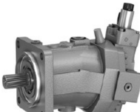
Motor hidraulic cu pistoane axiale și cilindree variabilă, reversibil, necesar pentru mecanismul de deplasare, presiune nominală 400 bar, presiune maximă 450 bar
