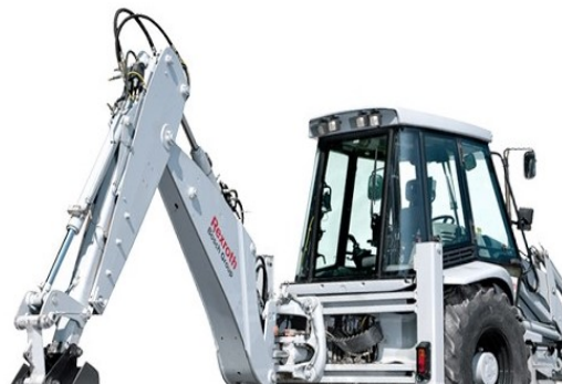
b) Model de utilaj multifuncțional specializat pentru săpare-încărcare frontală
