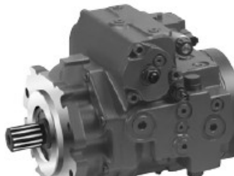
Pompa principală cu pistoane axiale și cilindree variabilă, necesară pentru acționarea mecanismului de deplasare cu funcționare în circuit închis, presiune nominală 400 bar, presiune max 450 bar
