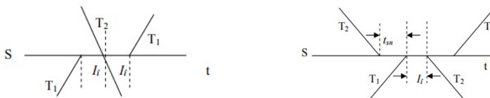
Fig. 6. Diagrama intervalului de încrucișare a două trenuri și a intervalului de sosire nesimultană a trenurilor într-o stație CF
