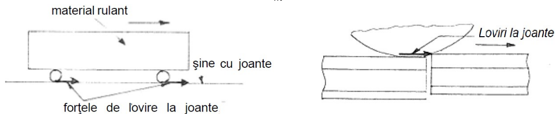
Fig. 1. Schematizarea solicitărilor dinamice la care sunt supuse capetele cupoanelor de șină în urma acțiunii eforturilor cu percuție exercitate de roțile vehiculelor feroviare în zona ecliselor
