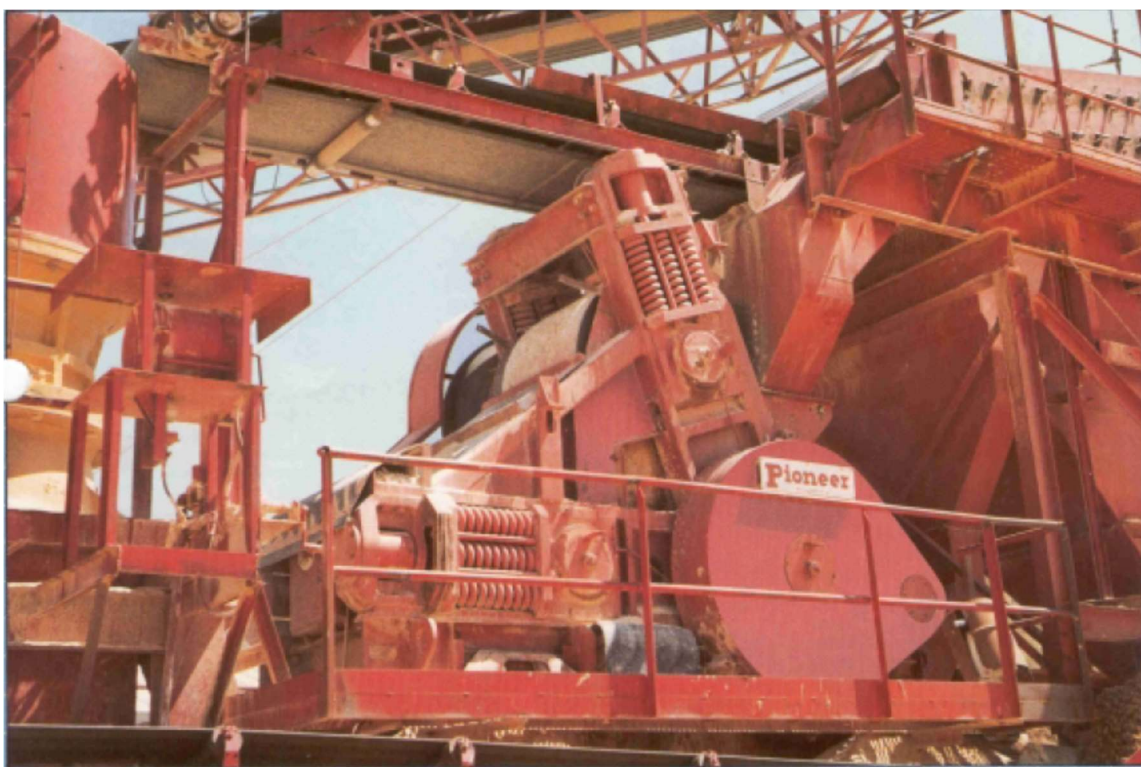
Figura 3. Concasor cu trei cilindri - PIONEER
